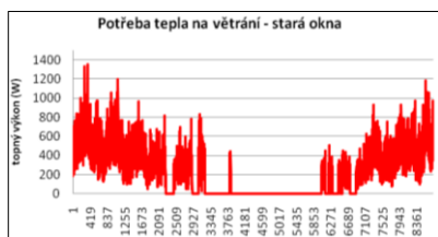
stará netěsná okna (var 1) \Sigma E_{\text{v\acute{e}t}} = 1780 \text{ kWh/rok}
