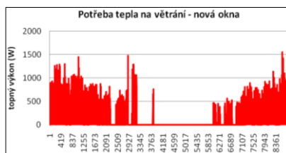
nová těsná okna (var 2) \Sigma E_{\text{v\acute{e}t}} = 740 \text{ kWh/rok}
