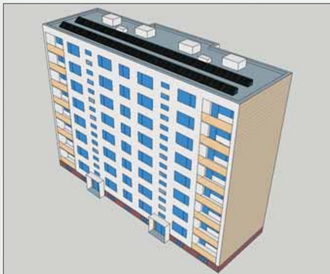
Schéma instalace fotovoltaických panelů na plochu střechy panelového domu. (Zdroj: Náprstek)
