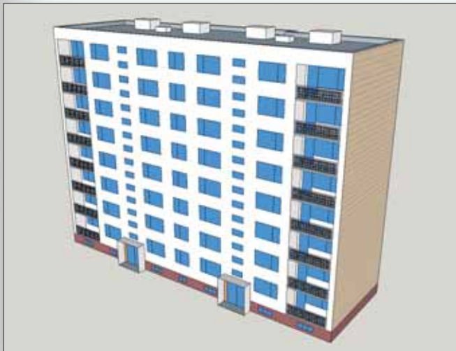
Schéma umístění fotovoltaických panelů na zábradlí lodžii a balkonů. (Zdroj: Náprstek)
