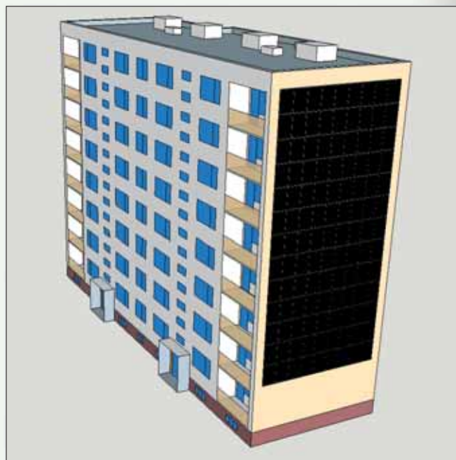
Schéma fotovoltaických panelů na štítové fasádě. (Zdroj: Náprstek)
