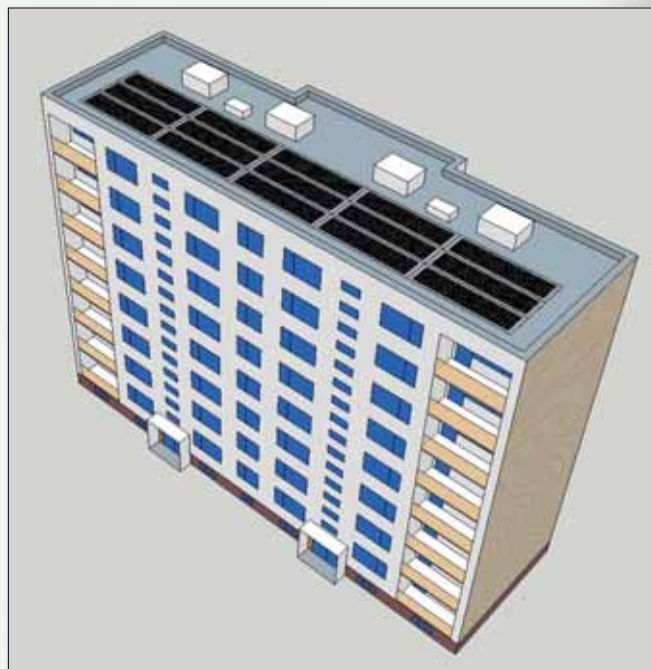
Schéma umístění tenkovrstvé fotovoltaické krytiny na plochu střechu objektu. (Zdroj: Náprstek)
