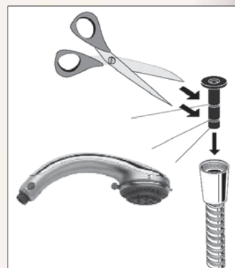
Nastavitelná sprchová hlavice a redukční kroužek pro omezení množství vody ve sprchové hadici. (Zdroj: Grohe, Ideal standard)
