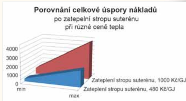
Celková úspora nákladů vlivem zateplení stropu suterénu za 40 let vztažená na užité podlahové plochy bytů při ceně tepla 480 Kč/GJ a 1 000 Kč/GJ. (Zdroj: EkoWATT)
